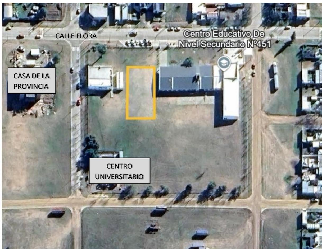
El playón de forma multidisciplinario, el cual medirá 40,00m x 20,00m, 800 m<sup>2</sup> de superficie, con demarcado para realizar futbol, vóley y básquetbol realizado con pintura alto tránsito de diferentes colores y de 5 cm de ancho. El espesor mínimo de hormigonado será de 0,10m.
